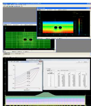
トンネル、埋立、斜面安定、耐震といった、わが国特有の地盤工学上の問題を解決する為に開発され、長年の実務を通じて培われてきた地盤解析の統合システムです。地盤変形解析 (線形/非線形/弾塑性)、圧密解析 (土水連成)、浸透流解析 (定常/非定常)、動的解析 (地震応答解析)、液状化解析 (地震時の土水連成)、およびALID手法による液状化残留変形解析を行うことができます。CAD操作による地盤と構造物の定義やメッシュの自動生成、アニメーション等による解析結果のビジュアル化などプレポスト機能が充実しています。
