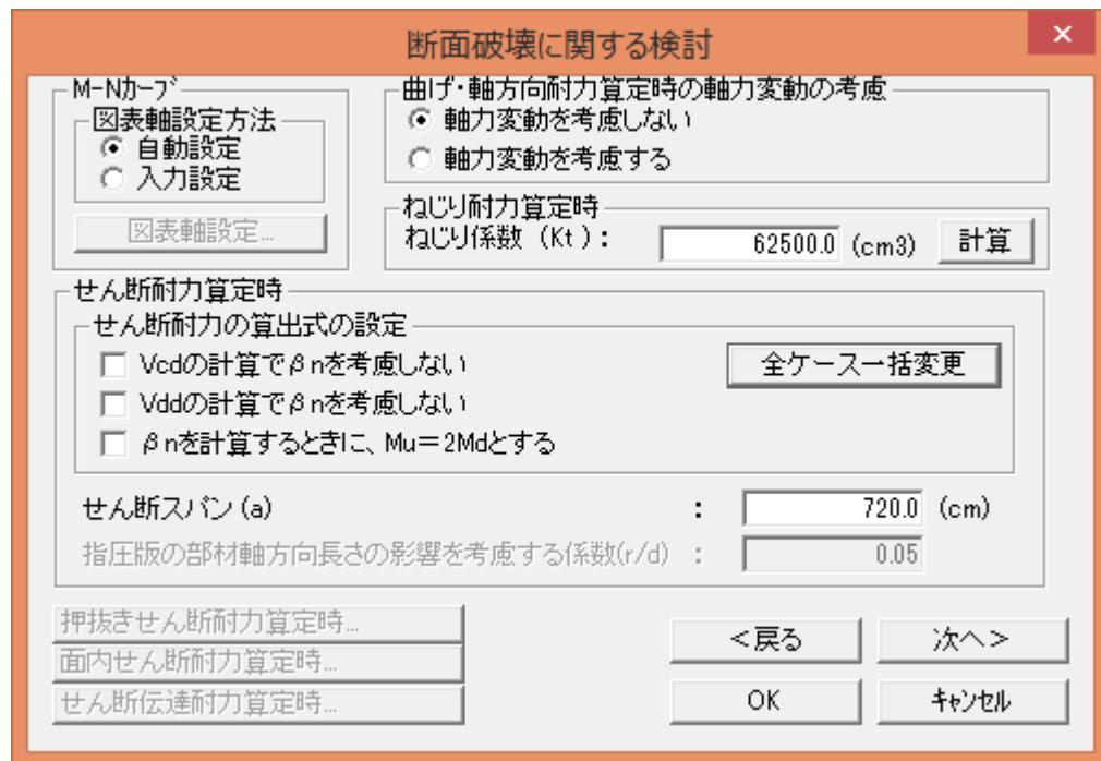
このうち、「Vcdの計算で $\beta_n$ を考慮しない」にチェックすると、 $V_{cd}$ の計算をV13.1C以前と同じ式で計算するようになります。また、「Vddの計算で $\beta_n$ を考慮しない」をチェックすると、 $V_{dd}$ の計算をV13.1C以前と同じ式で計算するようにできます。これらのチェックは個別に設定できます。また、両方にチェックを入れると、V13.1C以前と同じ結果を得ることができます。
