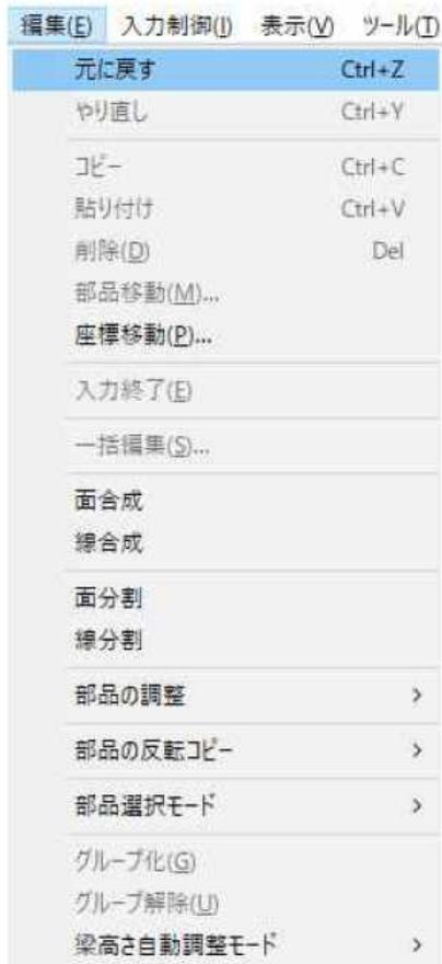
設定済みの梁の高さを変更した場合、接する面材・筋かい・柱の高さについて、自動調整モードを選択します。
