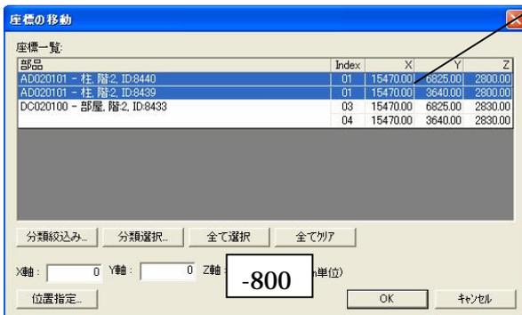
柱脚 (Index=1) を選択します。 部屋は選択を解除してください。
